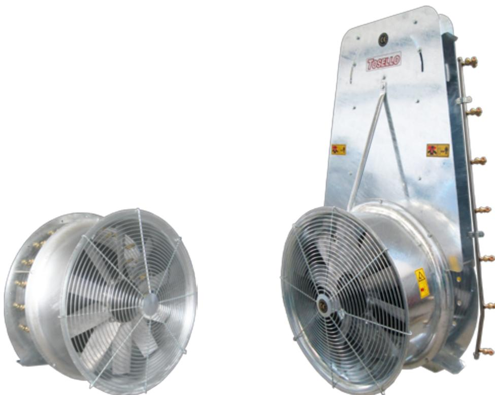
Corpo interamente zincato a caldo, ventola in alluminio a 10 pale registrabili, moltiplicatore ad ingranaggi a 2 velocità con rapporto 1:4/1:4,4, aste portagetto in acciaio INOX AISI 304. A RICHIESTA: getti doppi in ottone con antigoccia.
